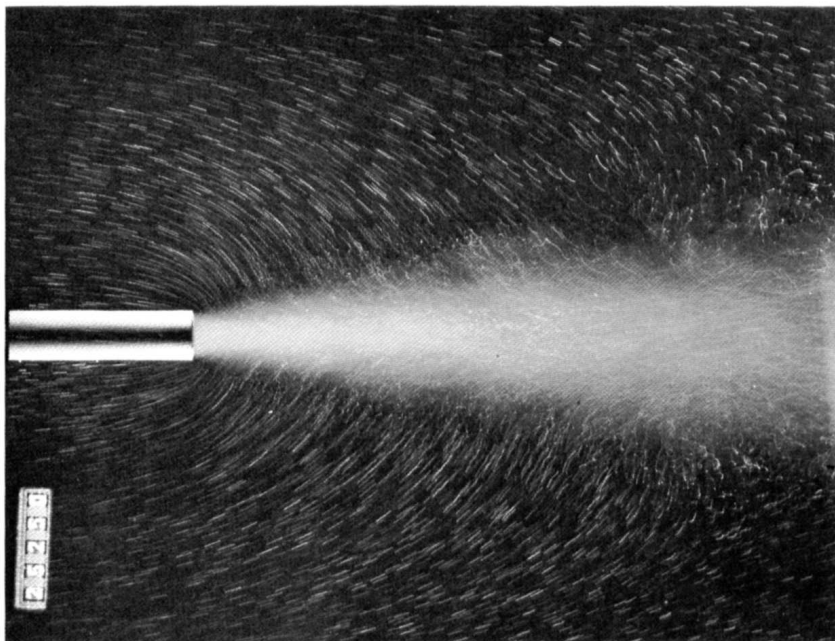
Figura 8.3: Fotografia di un getto assialsimmetrico turbolento da un tubo di 9 mm di diametro alla velocità di 200 cm/s (ONERA photograph, Werlé 1974).
