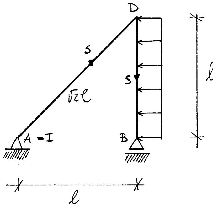
Il telais in esame è isostatico,  $m = 3$ ,  $\rho(B) = 3$
