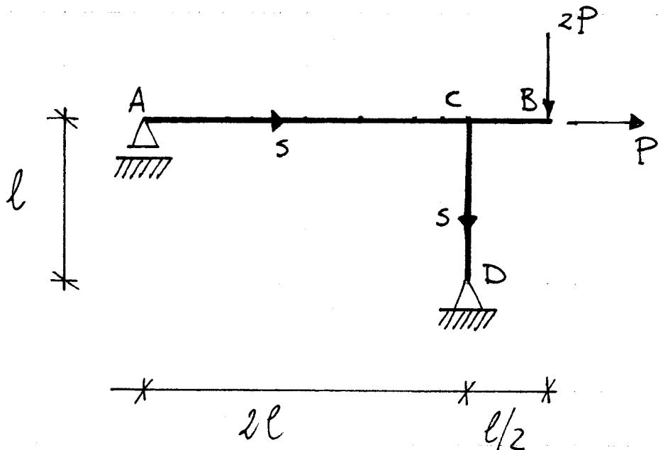
Il telaio in esame è instatico,  $m=3$ ,  $\rho(\underline{B})=3$
