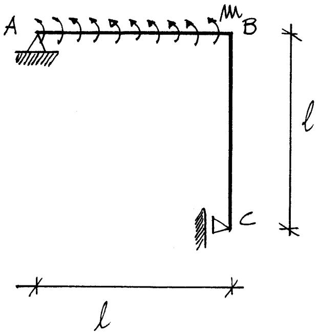
Il telaio in esame è isostatico,  $\mu=3$ ,  $\rho(B)=3$ .
