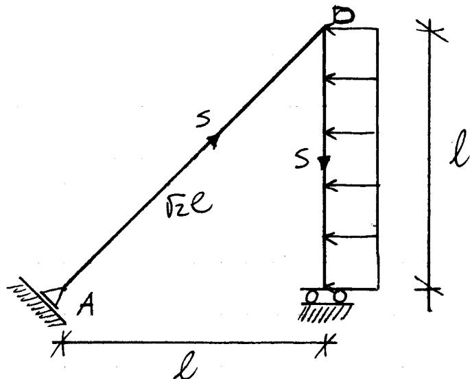
Il telaio in esame è isostatico,  $m=3$ ,  $\rho(B)=3$ .
