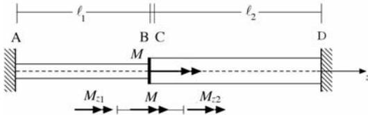
Sistema globale staticamente indeterminato solo a connessione delle flange avvenuta.
