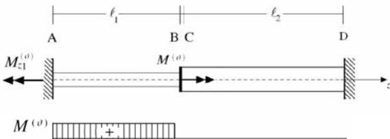
Sistema con la sola rotazione attivata dal momento torcente sul tratto AB. Il tratto AB si presenta staticamente determinato sino al valore della rotazione pari a  $1.5^\circ$  ( $0.026 \text{ rad}$ ) ( $J_1 = 0.165 \cdot 10^{-6} \text{ m}^4$     $J_2 = 7.952 \cdot 10^{-6} \text{ m}^4$ ).
