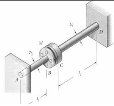
**Dati:**  $l_1 = 0.6 \text{ m}$     $l_2 = 0.9 \text{ m}$     $r_1 = 0.015 \text{ m}$     $r_2 = 0.018 \text{ m}$
