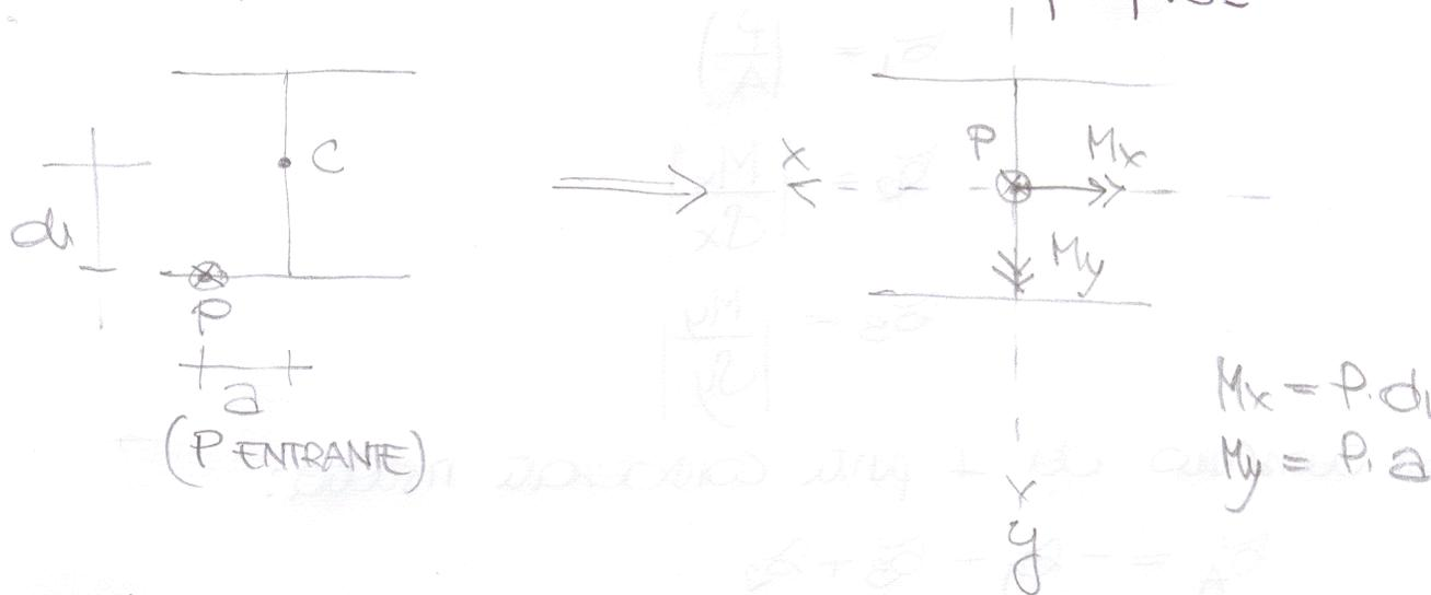
Il problema proposto richiede di determinare la deflessione  $a$  (dato il carico  $P$ , ed in alternativa di determinare il carico  $P$  assegnata  $a$ , o viceversa,  $a$ ) in modo tale che la massima tensione di compressione sia pari ad un dato valore assegnato. La tensione massima si realizzerà in uno dei 4 punti mostrati in figura:
