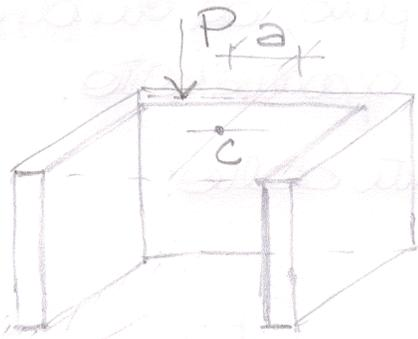
In primo luogo si sostituisce  $P$  con un sistema equivalente di forze applicato nel baricentro  $c$  del profilo;
