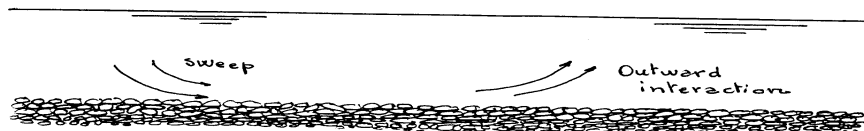
Figura 1.16: Schema illustrativo dell'azione delle strutture turbolente di parete responsabili dell'incipiente trasporto di fondo.
