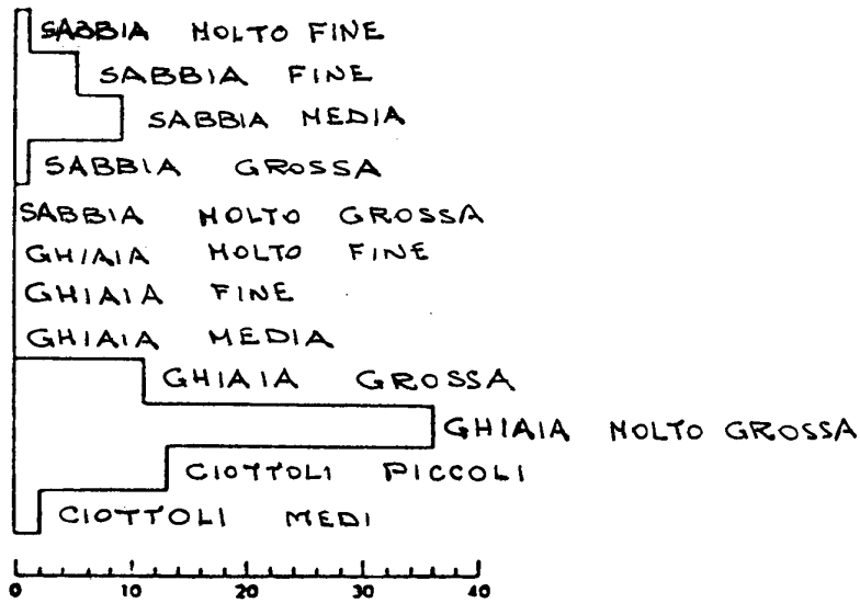
Figura 1.3: Istogramma che fornisce la frequenza con cui diversi valori del d_{50} relativo allo strato superficiale si osservano in 78 corsi d'acqua nella regione di Alberta, Canada (Parker & Peterson, 1980).
