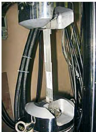
Figura 24: Esecuzione di prove sperimentali su provini "single lap shear"
