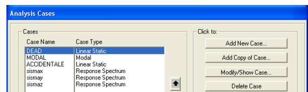
nell'*analysis case type* relative alle analisi sismiche si va a selezionare: *modify/show case* e si modificano le analisi sisma x, sismay, sismaz, scalando inoltre gli spettri a g:
