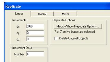
si ripete l'operazione duplicando i diagonali sul piano  $y=3.66m$  (selezionandoli con una finestra che li attraversa da dx a sn e poi con il comando *replicate*)
