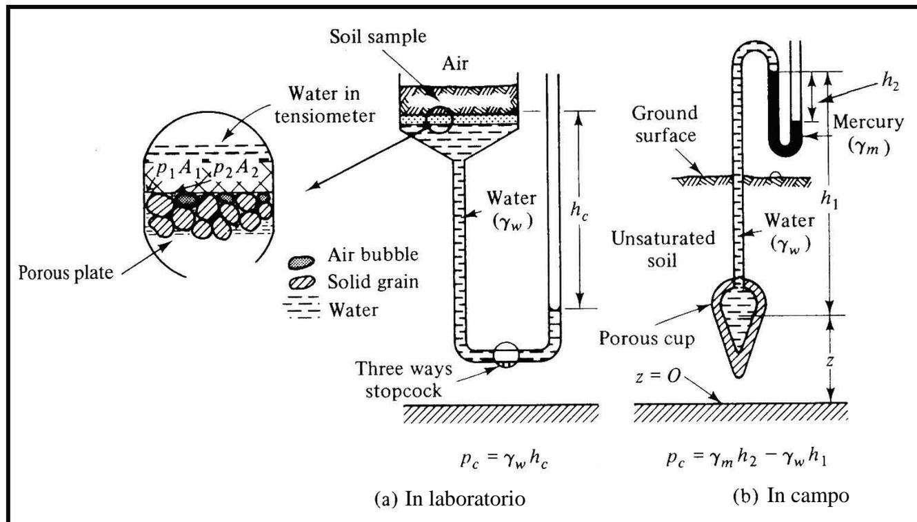
Una volta raggiunto l'equilibrio il manometro leggerà una pressione media sull'area di contatto tra l'acqua nel suolo e nel manometro stesso. Lo strumento prende il nome di **TENSIOMETRO**.
