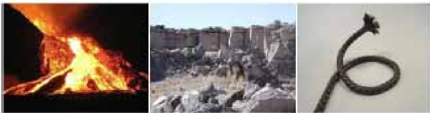
Figura 5: Dalla fusione della pietra basaltica si ottengono fibre continue con ottime proprietà meccaniche che possono essere intessute per ricavare corde. La fibra di basalto può vantare un'alta resistenza alle temperature elevate ed agli attacchi chimici.
