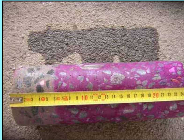
Carota dopo prova alla fenolftaleina
