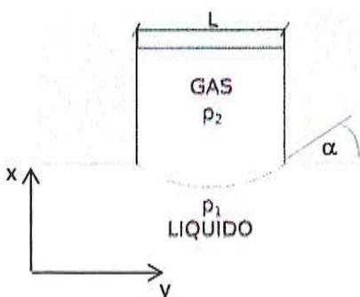
$$(p_2 - p_1) L \times \text{profondità} = 2 \sigma_s \times \text{profondità} \times \sin \alpha$$
