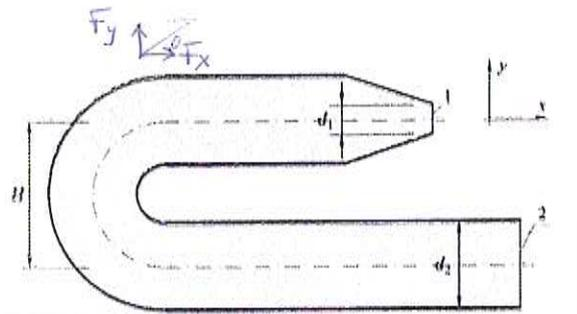
**ESERCIZIO 7.** Determinare la spinta dell'acqua (modulo, direzione e verso) sul gomito di figura, posto su un piano verticale. Il fluido scorre da 2 verso 1, sboccando in atmosfera, e il peso del fluido contenuto nel volume di controllo tra le sezioni 1 e 2 è pari a 272 N. Dati:  $\dot{V} = 54$  l/s;  $H = 1$  m;  $d_1 = 5$  cm;  $d_2 = 15$  cm.
