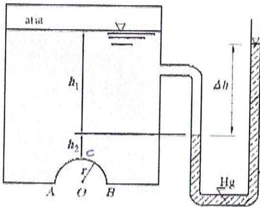
**ESERCIZIO 5.** Determinare la spinta dell'acqua sul fondello semisferico AB di figura. Il fluido ausiliario nel piezometro è mercurio.
