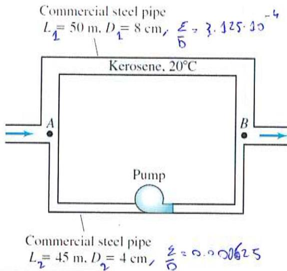
**ESERCIZIO 4.** Il sistema di tubazioni in parallelo di figura è realizzato in acciaio commerciale; trasporta kerosene ( $\rho = 804 \text{ kg m}^{-3}$ ,  $\nu = 2.4 \times 10^{-6} \text{ m}^2 \text{ s}^{-1}$ ) con una portata totale di  $0.05 \text{ m}^3 \text{ s}^{-1}$ . Quando la pompa non è in funzione la si può considerare come una perdita di carico concentrata con  $K_L = 1.4$ . Si determini la portata in ciascuno dei due rami e la caduta di pressione tra A e B.
