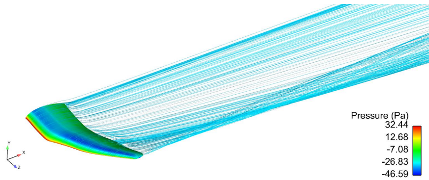
Figura 5.9: Visualizzazione della pressione statica e delle linee di corrente dell'ala (vista isometrica).
