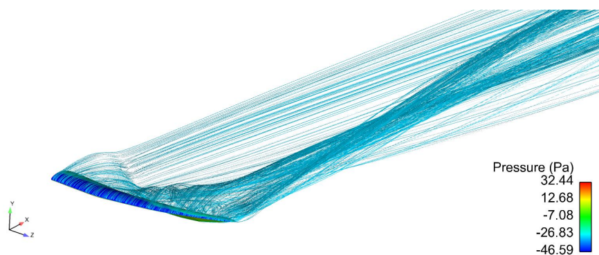
Figura 5.16: Visualizzazione della pressione statica e della scia tramite criterio-Q [52].
