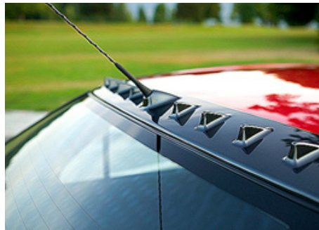
FIG. 1.13 – «Vortex generators» pour contr ler l' coulement de lunette arri re (Mitsubishi).
