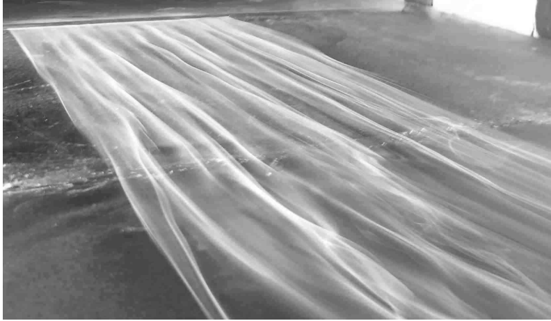
FIG. 3.32 – Visualisations par fumée de stries turbulentes sur plaque plane.
