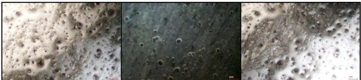
*Figura 25\_ LIS ingrandimento X100 stessa porzione di superficie per tutte le immagini; (sx) immagine in BF illuminazione radente da sinistra; (centro) immagine in DF pillars in evidenza; (dx) immagine BF con illuminazione radente da destra; scala rossa 100  $\mu$ m*
