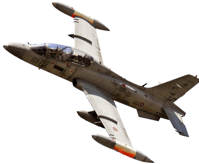
Figura 1.4: AerMacchi MB-339CD, si possono notare le paretine anti scorrimento a metà ala (Fonte: Aeronautica Militare)
