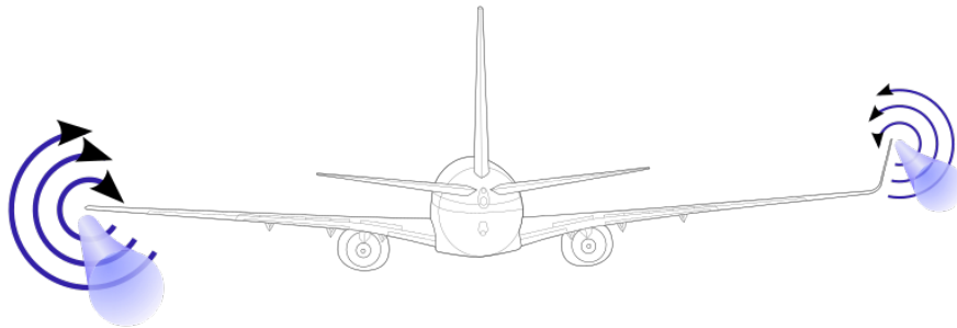
Figura 1.3: Vortici di estremità (fonte: https://aviation.stackexchange.com )
