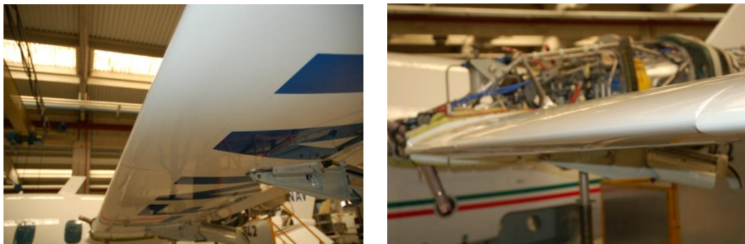
Fig.2.9 Particolare del bordo d'attacco installato
