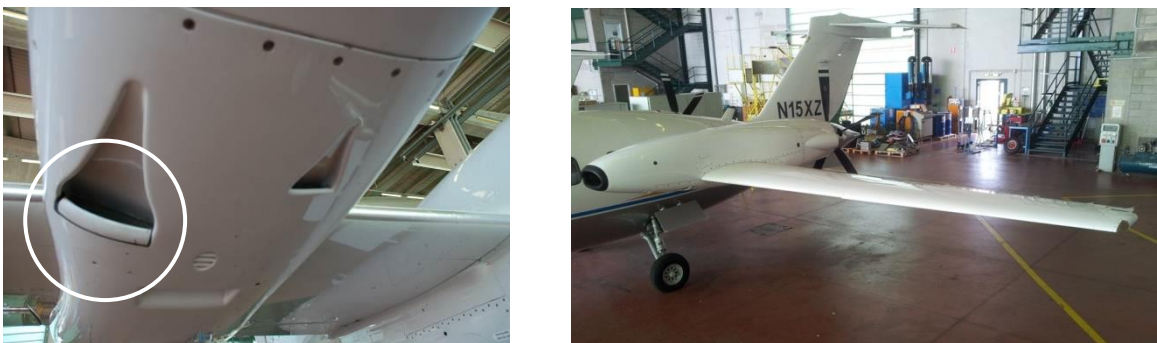
Fig.2.7 Bordo d'attacco della presa d'aria oil cooler e della semiala principale
