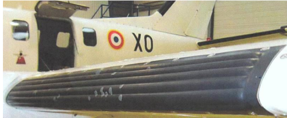
Fig.2.10 Esempio di sistema "boot" in funzione
