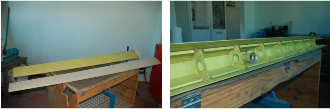
Fig.2.8 Bordo d'attacco sbarcato ed il suo distributore interno
