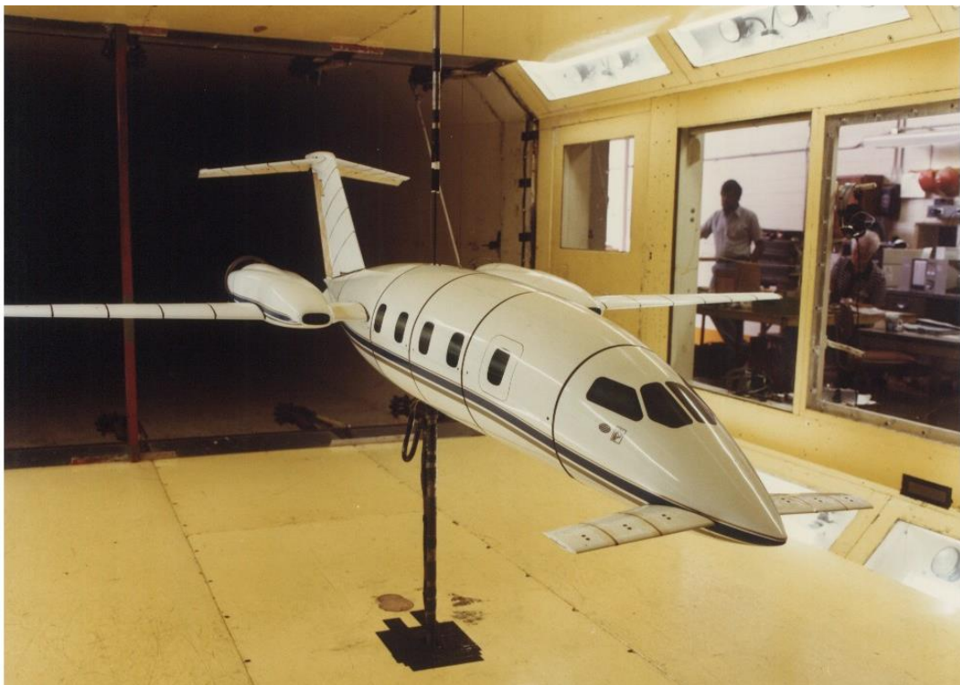
Figura 1.8 Modello aeroelastico del P.180
