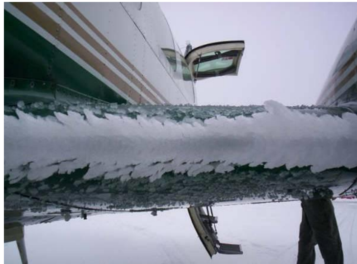
Fig.2.1 Formazione di ghiaccio sulla superficie alare
