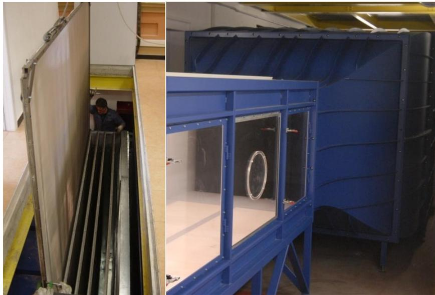
**Figura 5-1** Installazione del pannello a nido d'ape e delle reti (a); vista del convergente e della prima sezione di misura (b).
