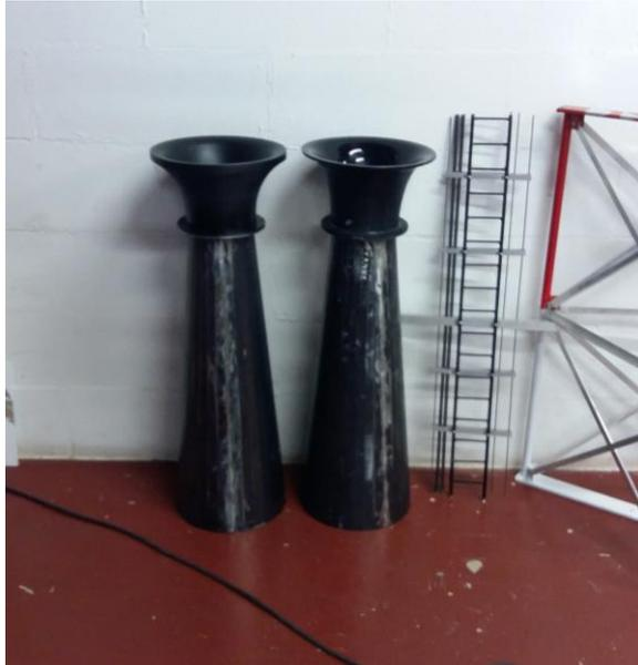
*Fig. 4.6 - Coni di ingresso e di uscita*
