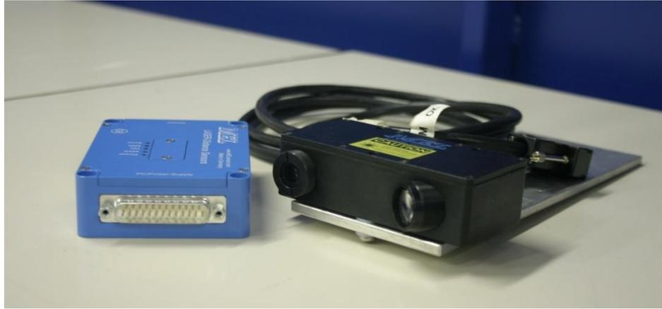
*Figura B.4*      *Sensore di spostamento laser.*
