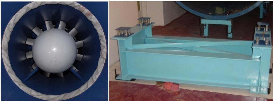
**Figura 2-1** Vista del ventilatore dal cambio di forma a monte (a) e del basamento su fondazione rigida (b).
