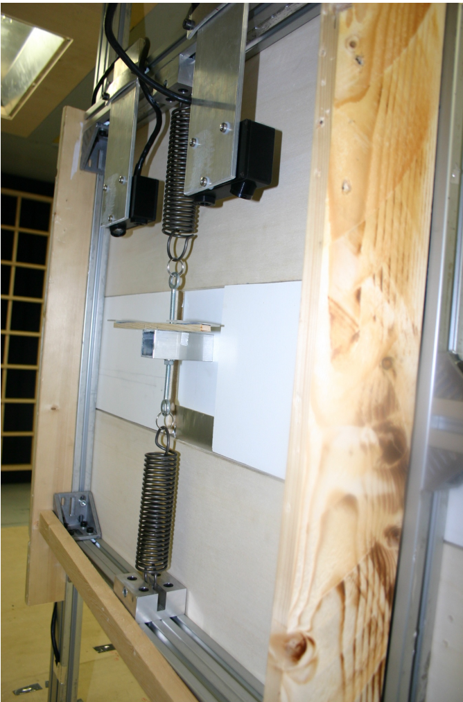
Figura 4.22. Montaggio a telaio dei sensori di posizione
