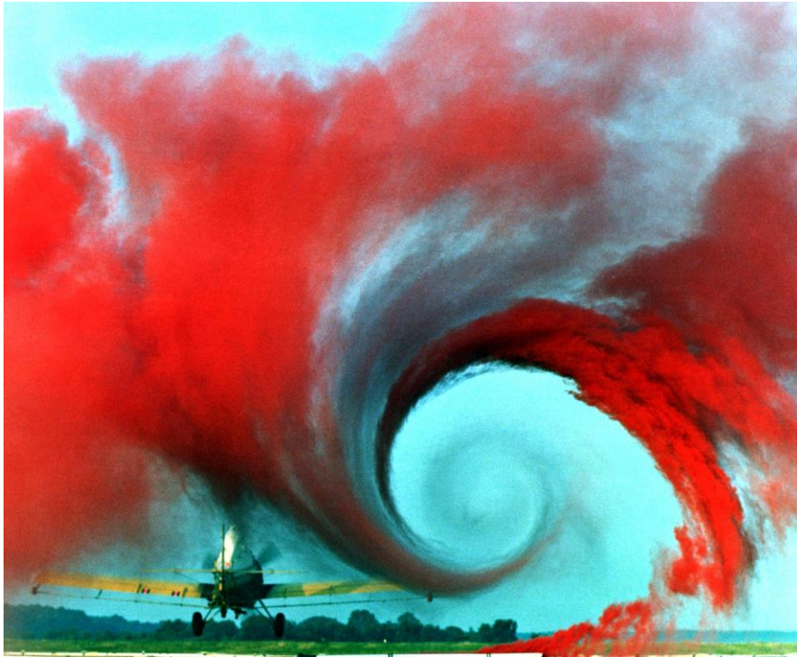
Figura 2.3 – Vortice di estremità causato dall'ala di un aeroplano
