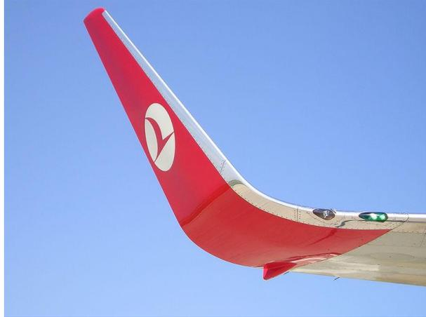
Figura 1.4: Esempio di *winglet* su un Boeing 737-800
