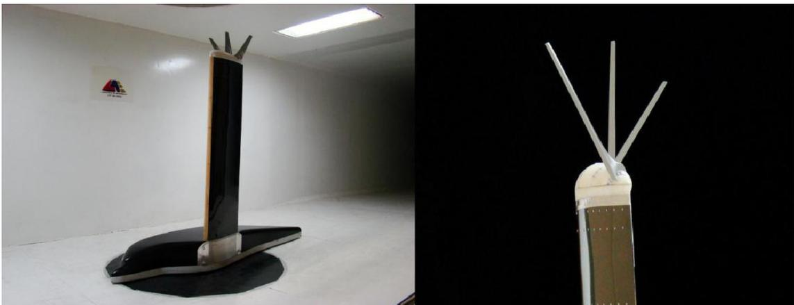
Figura 1.9: Modello preparato per le prove, a sinistra, e multi-winglets in configurazione 1, a destra [8]
