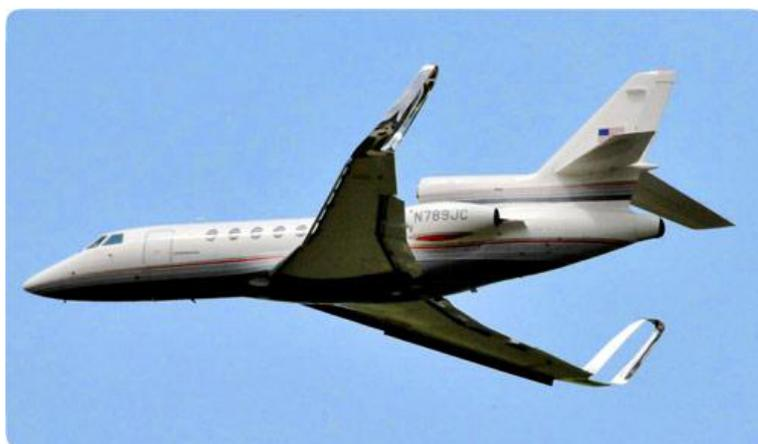
Figura 1.23: Dassault Falcon 50 equipaggiato con *winglets* spirodali
