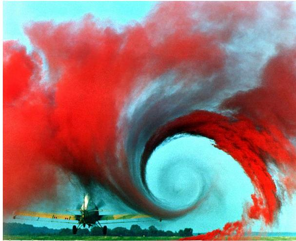
Figura 1.2: Esempio di tip vortex formato da un aereo agricolo che solleva fumo colorato da un campo (NASA Langley Research Center)
