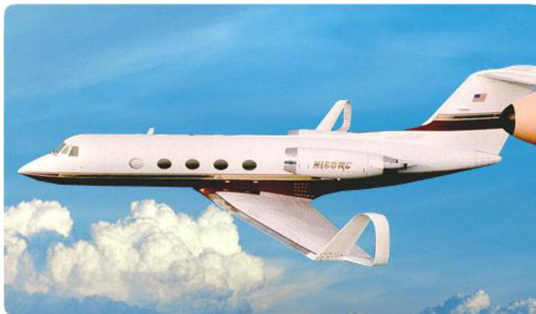
Figura 1.22: Globemaster II equipaggiato con *winglets* spirodali
