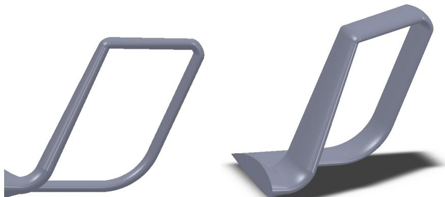
Figura 3.7: *Winglet* spiroidale realizzata per questo studio
