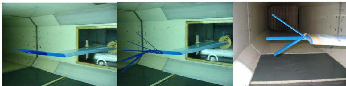
Figura 1.15: Alcune configurazioni alari testate [9]
