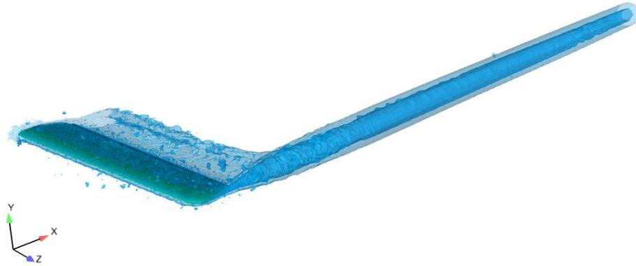
Figura 4.51: Confronto tra superfici a isovorticità e utilizzo del  $Q$ -criterion
