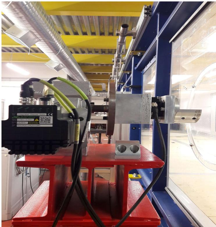
*Figura 3.1 Sistema di rotazione profilo.*
