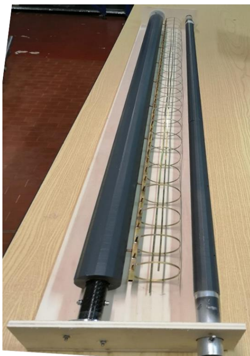
Figura 5.2 Modelli del palo: a sinistra il modello a sezione maggiore D con scala montata a destra il modello a sezione minore d .
