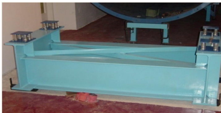
Figura 4.5 Vista del basamento su fondazione rigida.
