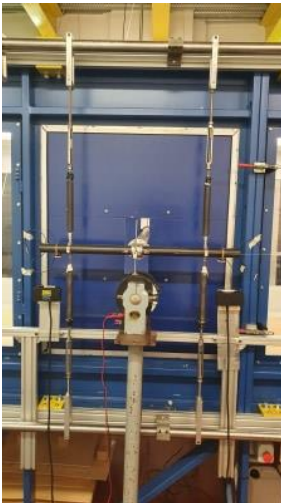
Figura 5.4 Sistema di ancoraggio del modello in galleria.
