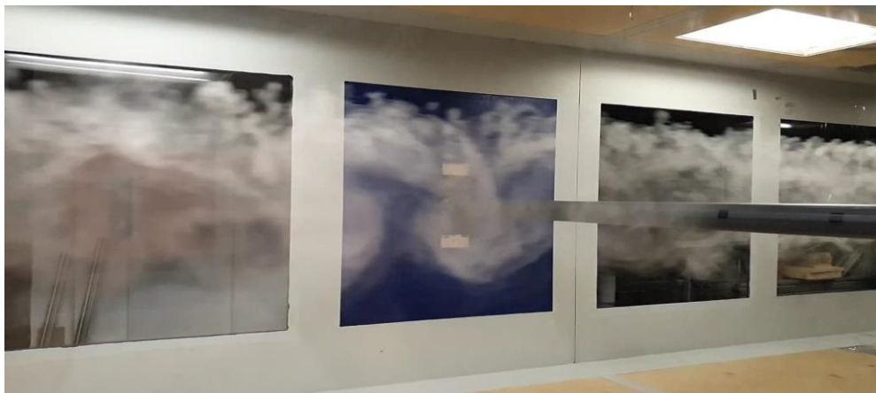
Figura 1.3 Distacco di vortici intorno al modello.
