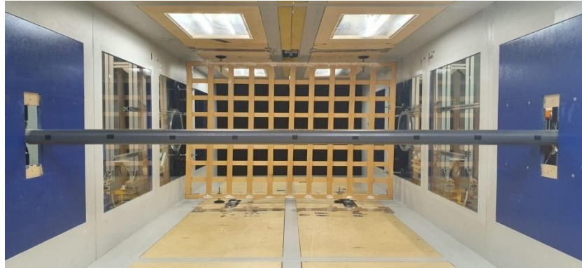
Figura 5.7 Vista frontale del palo con griglia di turbolenza.
