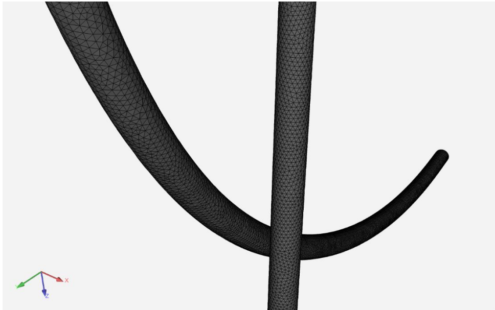
Figura 4.14 – Particolare della mesh dei cavi
