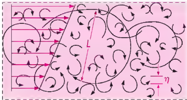
Figura 3.2 – Il metodo DNS simula tutti i vortici rilevanti nel moto, dai più piccoli (dimensione \eta ) ai più grandi (dimensione L )
