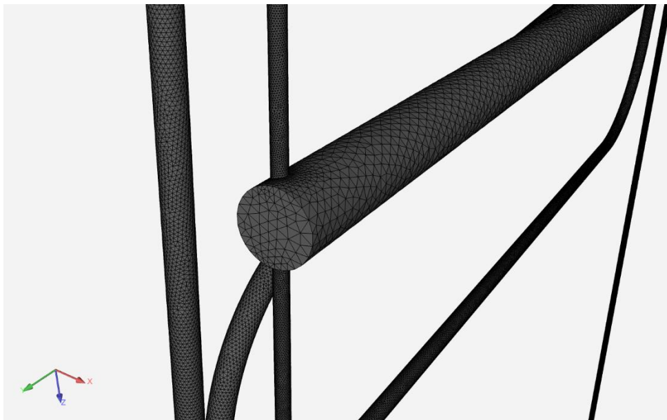
Figura 4.15 – Particolare della mesh della sbarra aggiuntiva
