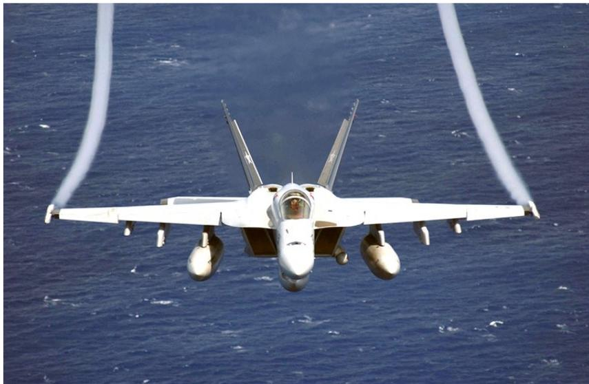
Figura 3.6: Vortici d'estremità, resi visibili dalla condensazione di vapore acqueo.
