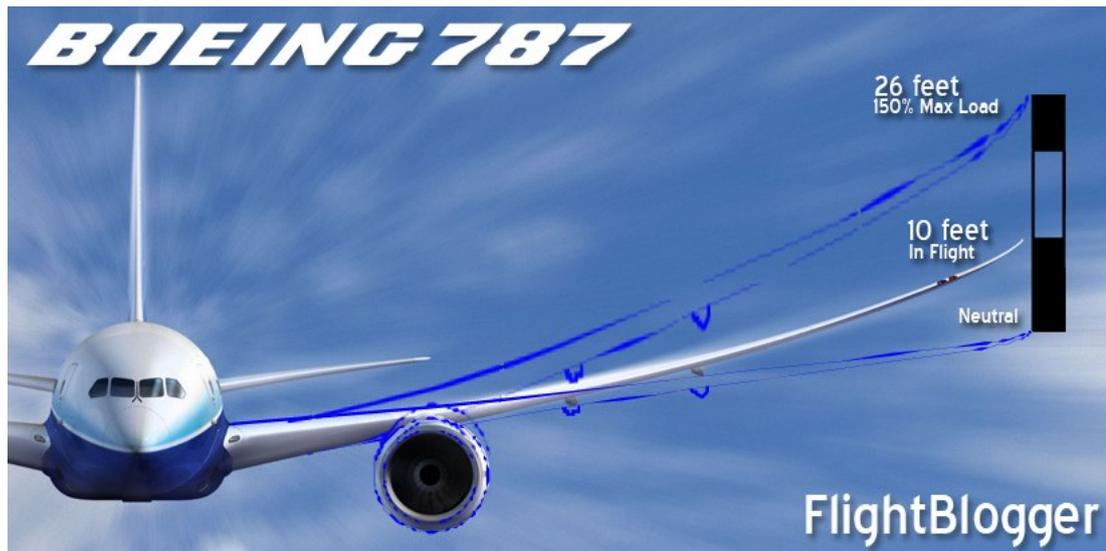
Figura 1.3.1: Configurazione alare a riposo, a regime di volo e flessione massima sopportabile di un Boeing 787 Dreamliner
