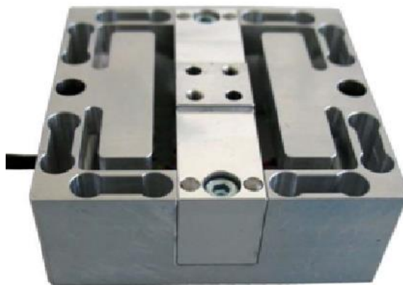
Figura 3.3 – Interface Advanced Force Measurements, cella di carico utilizzata per le misure di forza.
