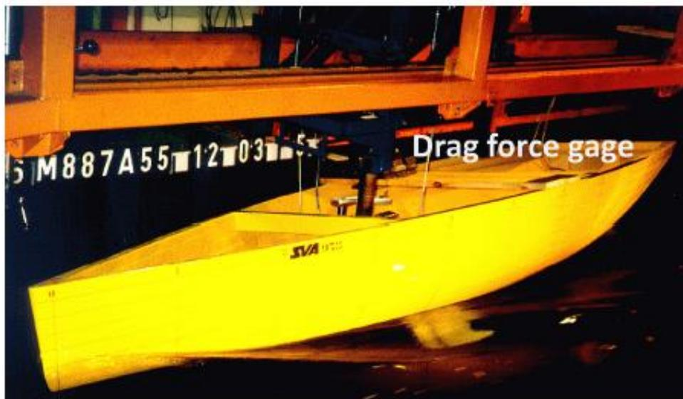
*Fig. 2.13 – Esperimenti in vasca navale usate per le misurazione di resistenza di forma e attrito*
