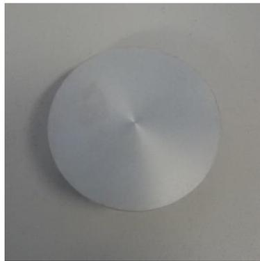
*Fig. 4.8 – Campione di vernice super-idrofobica*
