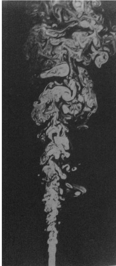
Figura 2.5 – Varietà di scale di vortici in un getto turbolento
