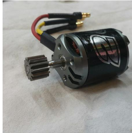
(b) Il motore con innestato il pignone. Si nota la variazione di diametro dell'albero
