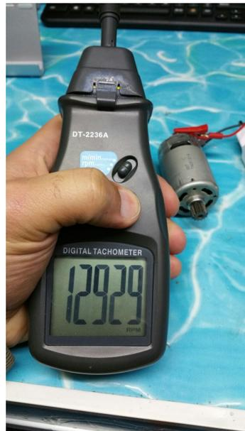
(a) Misura della velocità di rotazione all'albero motore
