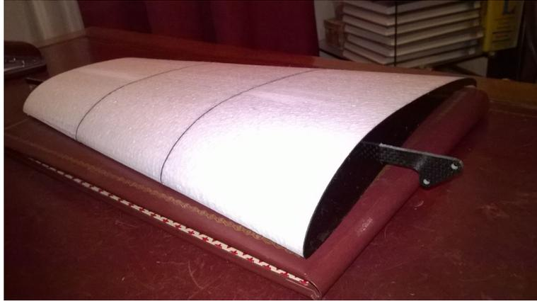
Figura 7.7: Fase intermedia di realizzazione del settore alare esterno. Si notano le centine di spessore  $0.5\text{mm}$  di carboresina e il riempimento in polistirolo.
