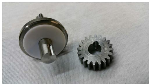
(h) La testa del riduttore tornita con l'albero saldato. Si nota l'incavo ricavato per il grano.
