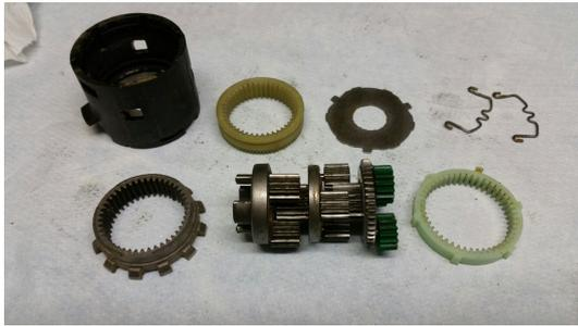
(a) Il riduttore disassemblato in ogni sua parte
