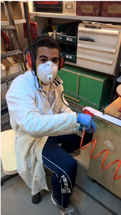
(a) Jacopo esegue il taglio di un longherone alare con il traforo manuale, si nota l'utilizzo dell'aria compressa per il raffreddamento della lama.
