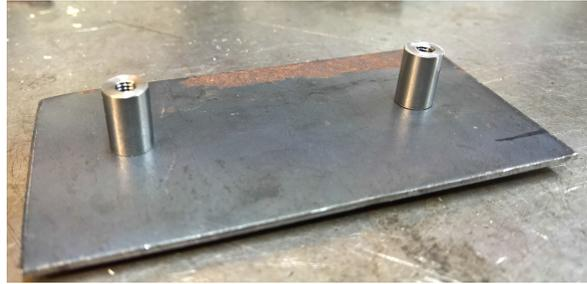
(d) La dima forata per la saldatura perpendicolare dei perni.
