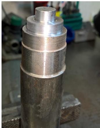
(a) La barra tornita per supporto alla saldatura
