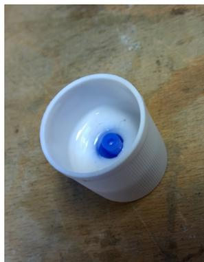
(b) Prima colata di prova per lo stampo di un piccolissimo ingranaggio
