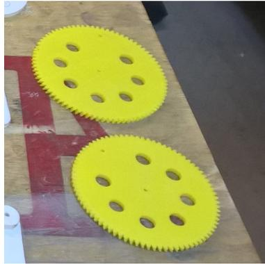
(a) Le due ruote dentate in ABS giallo
