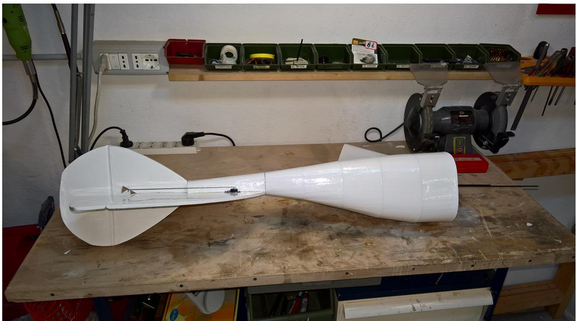
Figura 9.14: Fusoliera realizzata con coda classica.
