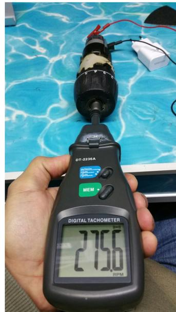
(b) Misura della velocità di rotazione all'uscita del riduttore
