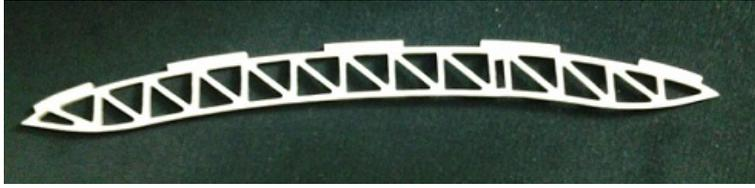
Figura 7.6: Una centina del primo settore, si nota la forma della camber line del profilo selig 1223 e i denti superiori per migliorare l'incollaggio alla lastra di ricopertura
