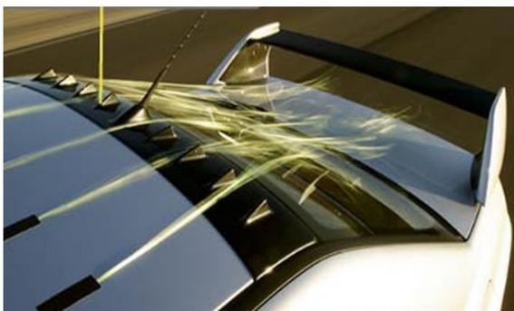
Figura 3.7: Generatori di vortice applicati sul tettuccio della Mitsubishi Lancer Evo IX del 2005, figura tratta da [4]
