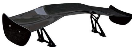
*Figura 3.10: Alettone posteriore a singolo elemento*
