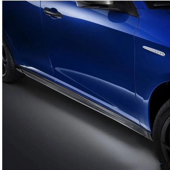
*Figura 3.4: Dettaglio di una minigonna per un'Alfa Romeo Giulietta.*
