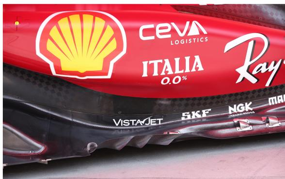
Figura 3.8: Generatori di vortice applicati sul marciapiede del fondo Ferrari, figura tratta da [5]
