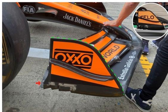
Figura 3.9: Endplates sull'ala anteriore della McLaren F1, figura tratta da [6]
