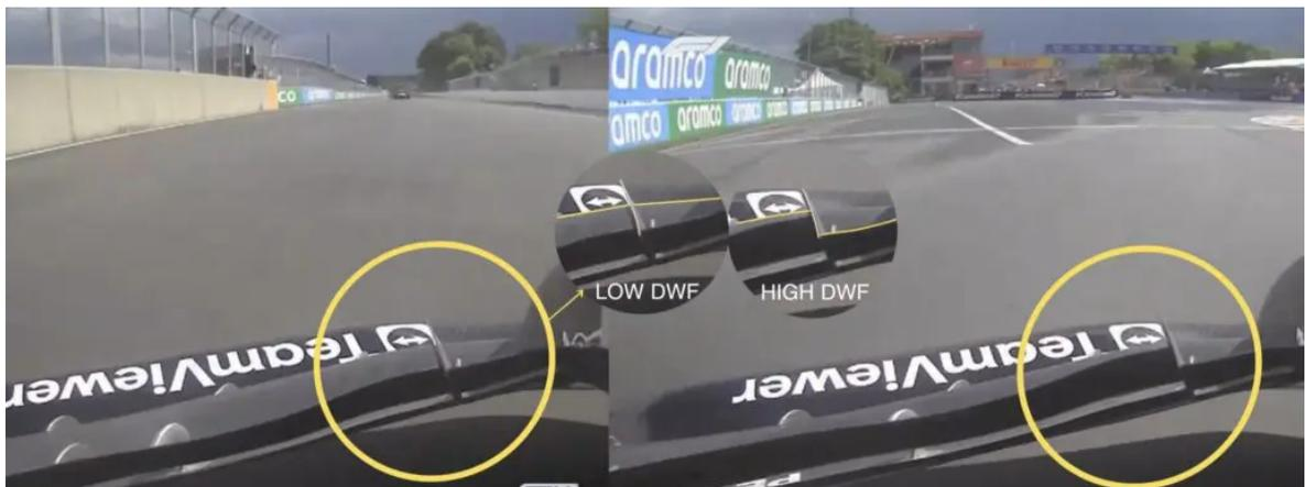
Figura 5.1: Differenza nell'incidenza dell'ala anteriore sulla Mercedes F1 di Russel nel gran premio del Canada 2024, figura tratta da [7]
