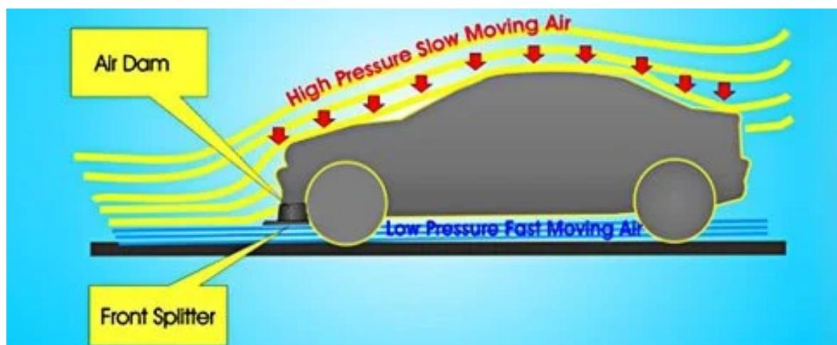
Figura 3.3: Divisione dei flussi dovuta all'utilizzo dello spoiler anteriore e dello splitter.
