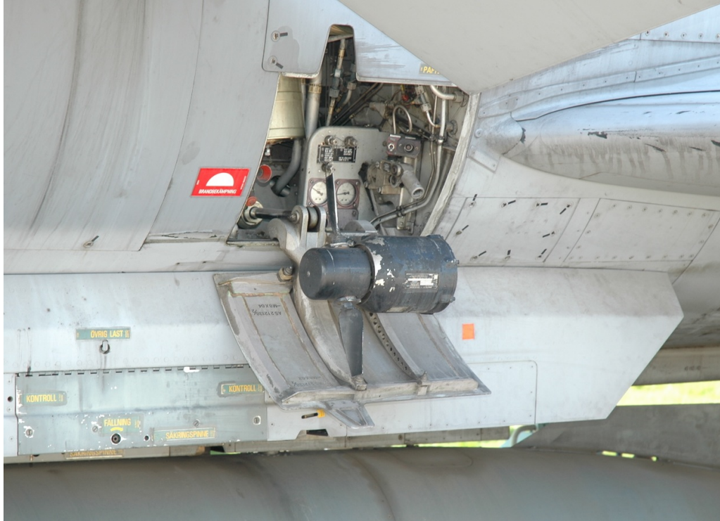
Fig. 3.2: Emergency retractable RAT of a SAAB J-37 Viggen. Wikimedia Commons
