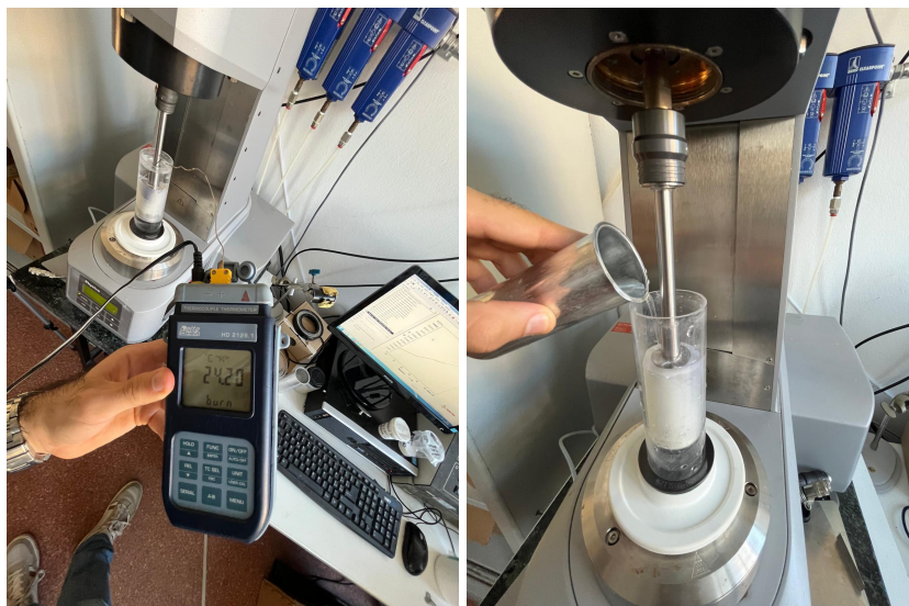
Figura 3.9: Foto raffiguranti l'acquisizione delle misure di temperatura e l'inserimento delle HSG
