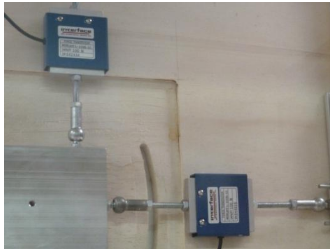
Fig.3. 17: Celle di carico, particolare
