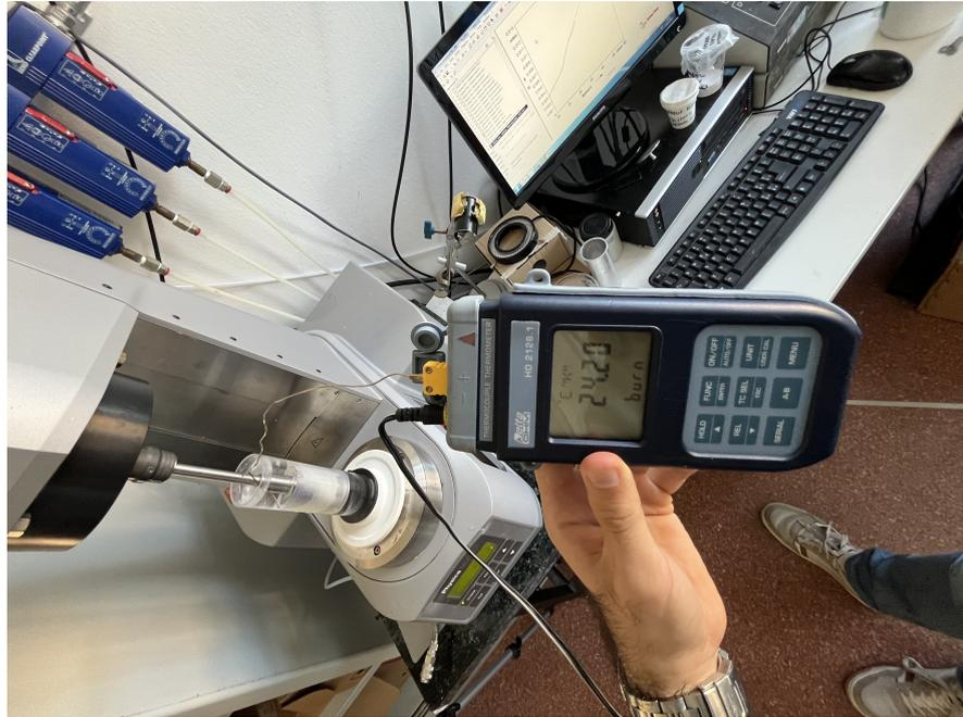
Figura 3.10: Termocoppia inserita nel fluido
