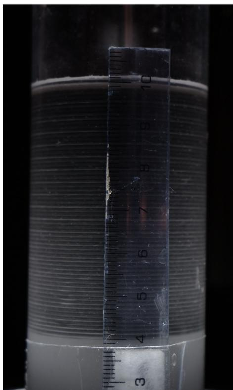
*Figura 4.41: Vortici completamente sviluppati in un 1000S*
