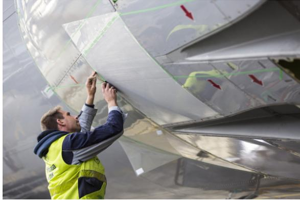
Figura 1.4: Un tecnico installa un plastic film di riblets sulla fusoliera di un Boeing 777-Er Cargo (2024).
