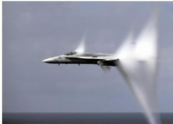
*Figura 7.1: Onda d'urto di ricompressione*
