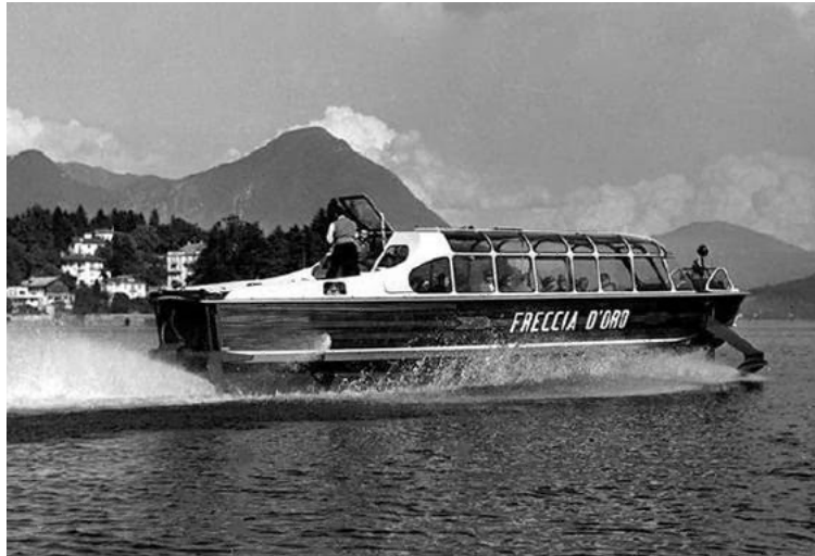
Fig. 2.2 – Aliscasfo PT.10, Freccia d’oro, costruito dalla Supramar nel 1953. Ospitava 32 passeggeri alla velocità di crociera di 65 km/h.
