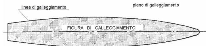
Fig. 1.23 – Vista del piano di galleggiamento
