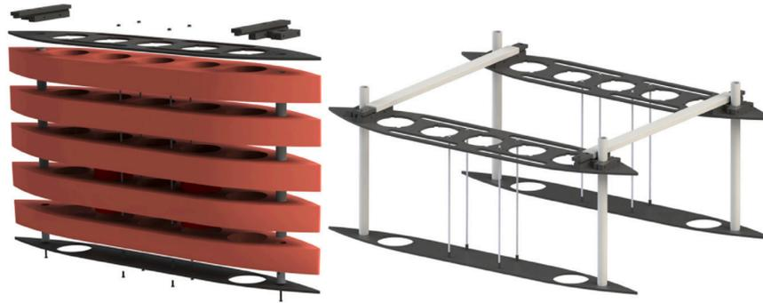
Figura 2.1.2 Vista esplosa dello scafo a sandwich e della struttura rigida di SWAMP.
