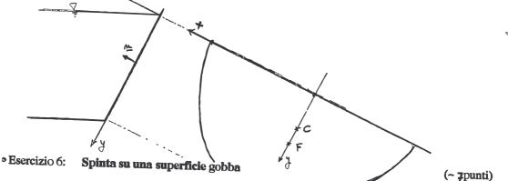
Data la superficie gobba  $\overrightarrow{AB}$  di figura si calcoli la spinta risultante dell'acqua sulla superficie (modulo, direzione e verso del vettore <u>F</u>).
