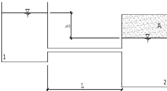
Calcolare il diametro necessario a far defluire una portata  $Q$  pari a  $1\text{l/s}$  nella condotta in figura.  $L=20\text{m}$ ,  $h=1\text{m}$ ,  $\rho_0=21,5\text{kN/m}^2$ ,  $\gamma_r=0,25\text{mm}$ .
