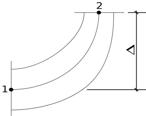
Nella condotta circolare in figura fluisce una portata di 30l/s d'acqua in moto stazionario. Sapendo che nella sezione 1 il diametro è pari a 30 cm e la pressione è pari a  $10\text{kN/m}^2$ , mentre nella sezione 2 il diametro è 15 cm, valutare la pressione nella sezione 2 sapendo che  $\Delta$  vale 50 cm.
