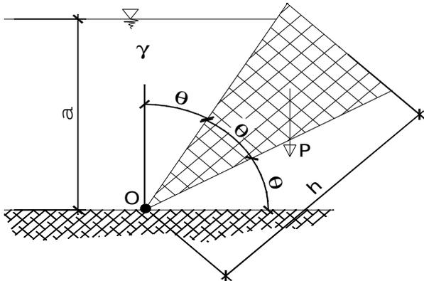
Determinare il momento necessario per tenere in equilibrio la paratoia in figura sapendo che  $a=3\text{m}$ ,  $P=100\text{kg/m}$ ,  $h=8\text{m}$  e  $\rho=1030\text{ kg/m}^3$ .
