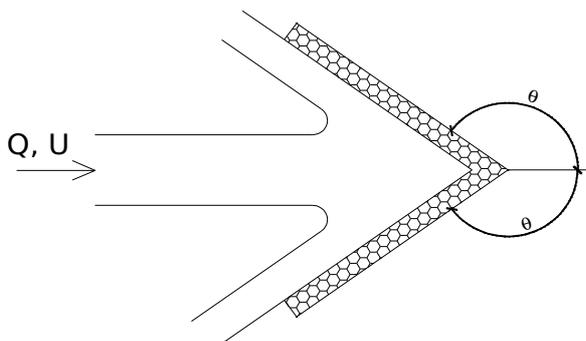
Valutare l'angolo di inclinazione  $\theta$  del deviatore in figura affinché si produca una spinta pari a  $7500\text{ N}$ .  $Q=18\text{kg/s}$ ,  $U=250\text{m/s}$ .
