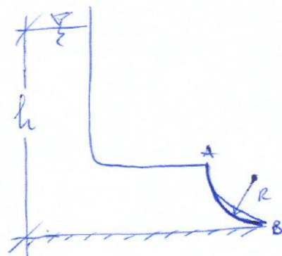
Per calcolare la forza idrostatica sul cilindro consideriamo la distribuzione di pressione sulla superficie gobba AB
